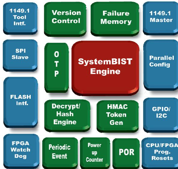
Figure 12. SystemBIST IC Block Diagram
